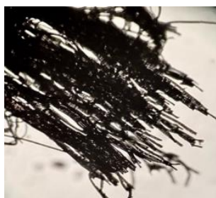
Рис. 2. Фотография преокисленных модифицированных силиконовым каучуком СКТН-А нитей полиакраамида (кратность увеличения 3,2X)
